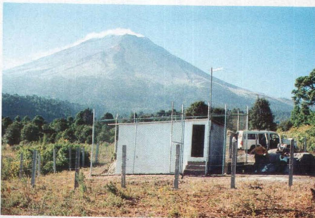
Figura 33. Caseta de protección en la estación Colibrí, Pue. (PPC) en la ladera Sureste del volcán. La caseta es de mampostería y fue construida por la Unidad de Protección Civil de Puebla. Está adicionalmente rodeada por una reja de malla ciclónica y una cerca de alambre de púas para impedir el acercamiento del ganado, noviembre 1994.
