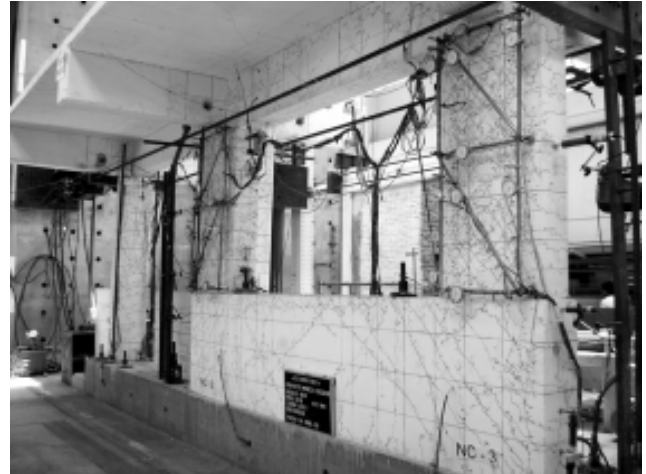
Refuerzo estructural de un modelo tipo de edificación escolar
