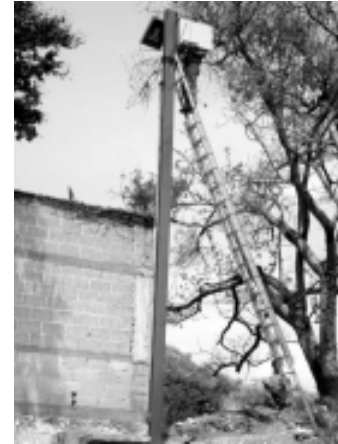
Revisión de la estación de nivel Campestre, del SAH de Tuxtla Gutiérrez
