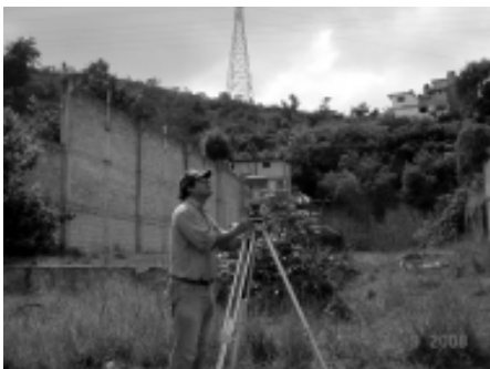
Monitoreo geodésico de deformación con GPS en la ladera de la colonia la Aurora en la ciudad de Teziutlán, Puebla
