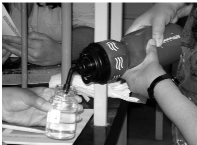
Pruebas a un filtro portátil para casos de emergencia
