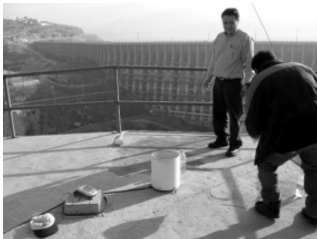
Limpieza de pluviómetros en Tijuana, B. C. (estación la presa)
